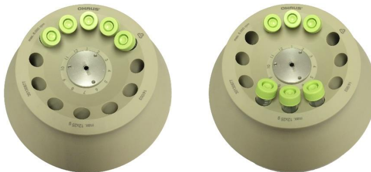
Abbildung.13-1 FALSCH Abbildung.13-2 KORREKT (6 Röhrrchen)
